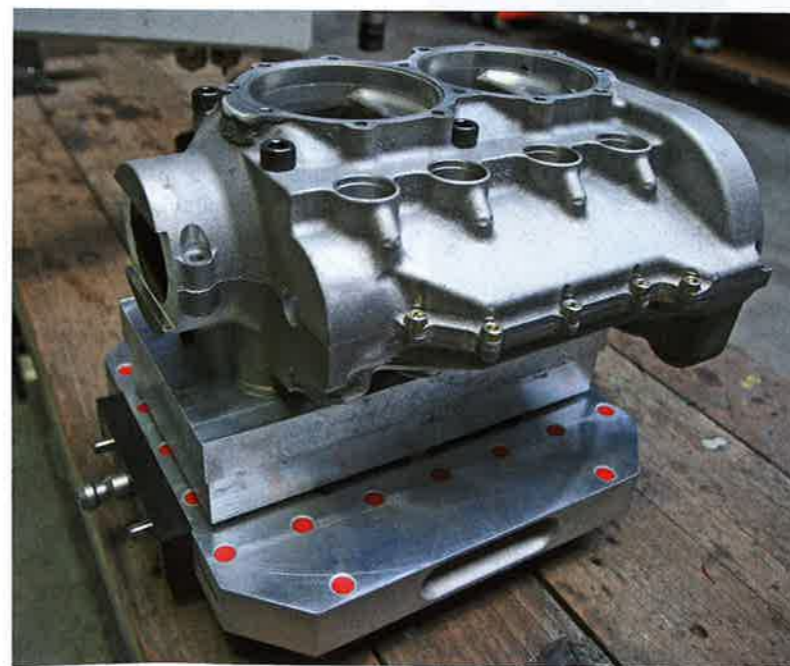
Les deux demi-flasques de la partie centrale du moteur prêtes à recevoir les cylindres.
