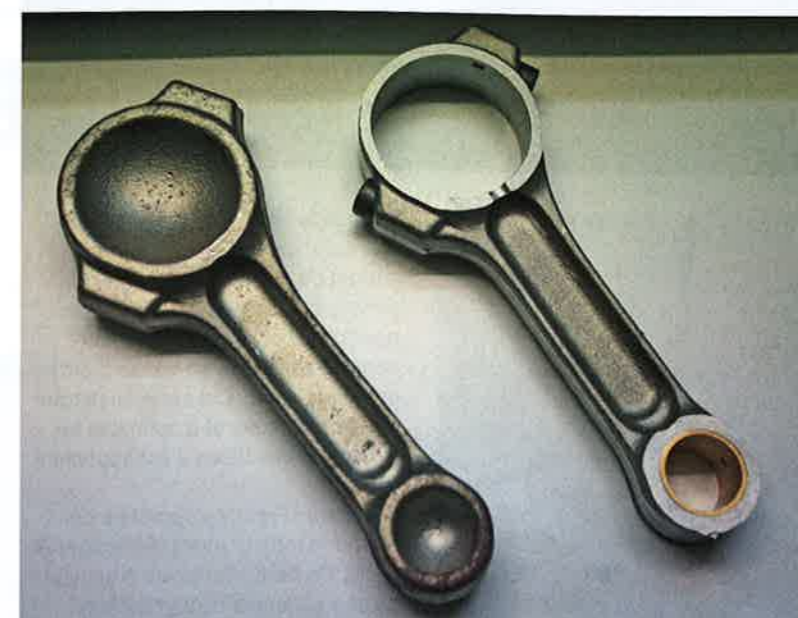
Avant, après. On peut voir sur ce cliché des éléments brut de fonderie et ceux prêts à l'emploi. La finition est réalisée dans les ateliers D-Motor.
