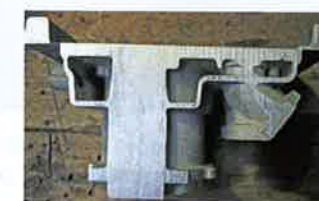
Le D-Motor est entièrement à refroidissement liquide. On voit ici les circulations qu'emprunte le liquide.
