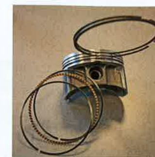
Les pistons sont équipés de 2 segments et d'un racleur d'huile.
