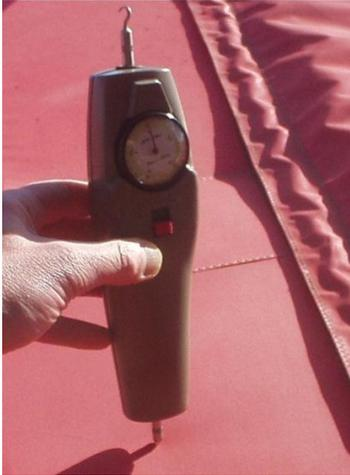
Le fil utilisé pour l'assemblage des tissus a une résistance à la traction de 5 kg quand il est neuf
